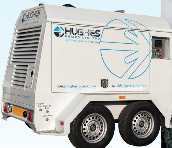
Čerpadlo Ultrabar 30 DRT(4), tlak 3 000 bar, průtok 24 l/min
