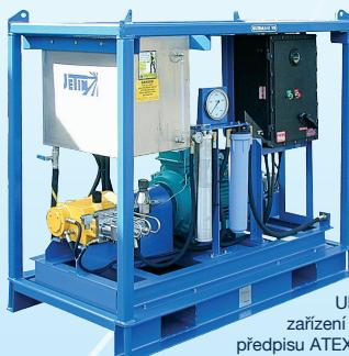
Ultrabar 10, zařízení využívající předpisu ATEX pro zónu 2, průtok 8 l/min, tlak 2 100 bar
