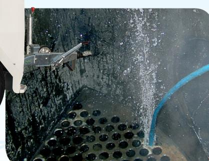
Čištění výměníku tepla – 800 bar
